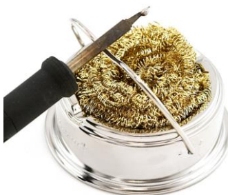
Curățarea vârfului de lipit - imagine preluată de pe learn.sparkfun.com
