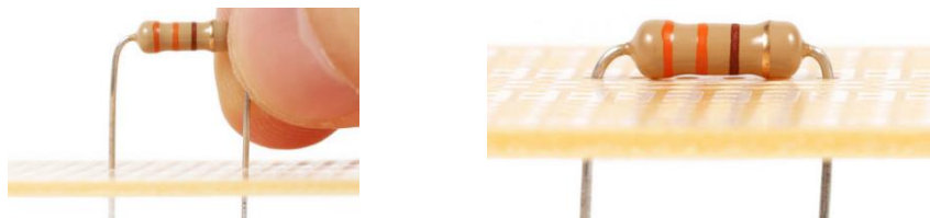
Îndoirea terminalelor și introducerea în găuri. Imagine preluată de pe www.instructables.com
